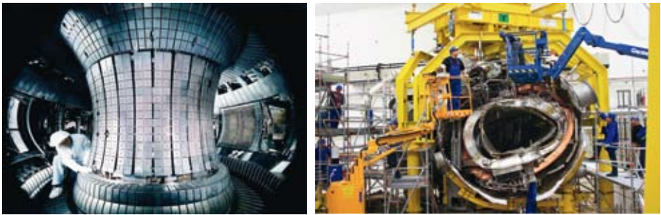
Abb. 5: Die Plasmakammer des Tokamaks ASDEX Upgrade in Garching (links) und der im Aufbau befindliche Stellarator Wendelstein 7-X in Greifswald (rechts)
